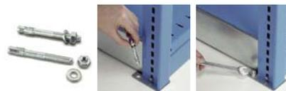
Materiale per fissaggio composto da 2 viti ad espansione in acciaio M8x75 mm per pavimenti in calcestruzzo non fessurato uguali o maggiori alla classe: B25 / RBK250 / MP<sub>A</sub> 25N per mm<sup>2</sup>.
