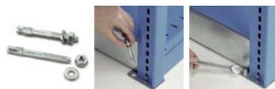
Materiale per fissaggio composto da 2 viti ad espansione in acciaio M8x75 mm per pavimenti in calcestruzzo non fessurato uguali o maggiori alla classe: B25 / RBK250 / MPa 25N per mm<sup>2</sup>.
