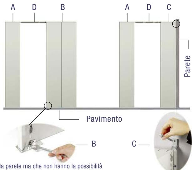
**ATTENZIONE:** il traversino di collegamento serve per le fiancate con l'obbligo di fissaggio alla parete ma che non hanno la possibilità di essere fissate alla parete stessa. In questo caso la fiancata in oggetto dovrà essere collegata ad una fiancata doppia con fissaggio a terra oppure ad una fiancata fissata a parete.
