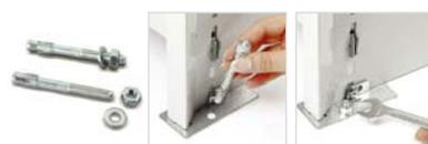
Materiale per fissaggio composto da 2 viti ad espansione in acciaio M8x75 mm per pavimenti in calcestruzzo non fessurato uguali o maggiori alla classe: B25 / RBK250 / MP<sub>A</sub> 25N per mm<sup>2</sup>.
