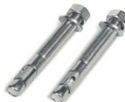
Materiale per fissaggio composto da 2 viti ad espansione in acciaio M16x140 mm per pavimenti in calcestruzzo non fessurato uguali o maggiori alla classe: B25 / RBK250 / MPa 25 N per mm<sup>2</sup>.
