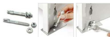
Materiale per fissaggio composto da 2 viti ad espansione in acciaio M8x75 mm per pavimenti in calcestruzzo non fessurato uguali o maggiori alla classe: B25 / RCK250 / MP<sub>A</sub> 25N per mm<sup>2</sup>.
